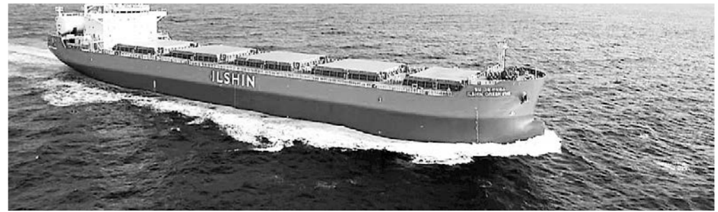
포스코의 고방간강이 세계최초로 적용된 LNG추진선 그린아이리스호 시운전 모습
